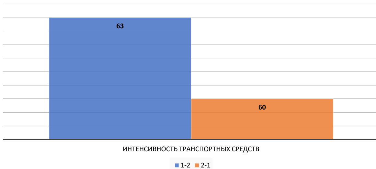
Рисунок 1.8.1.5 – Результаты замеров интенсивности транспортных средств (в приведенных единицах) за средний «час пик».
